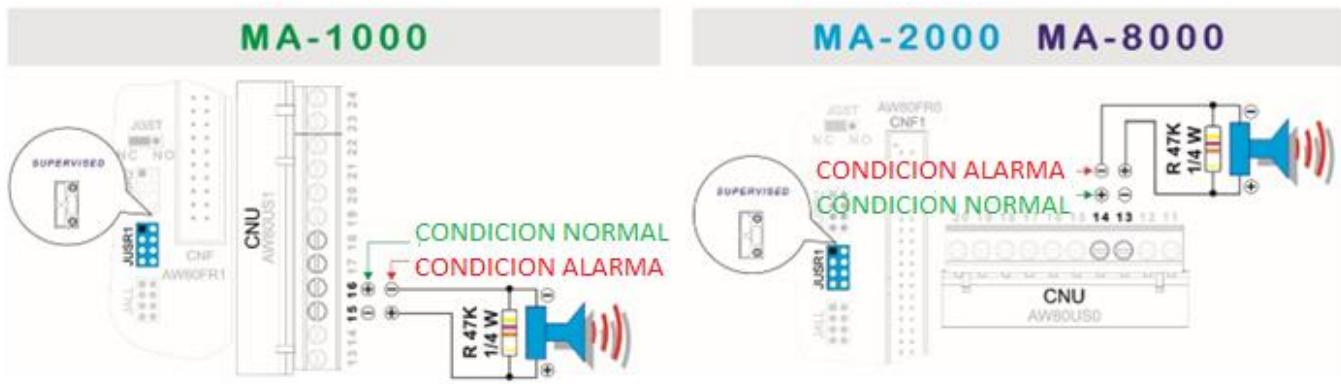
➤ **Dispositivos NO polarizados (sirenas, Relé, etc.) > Fin de línea: RESISTIVO**
