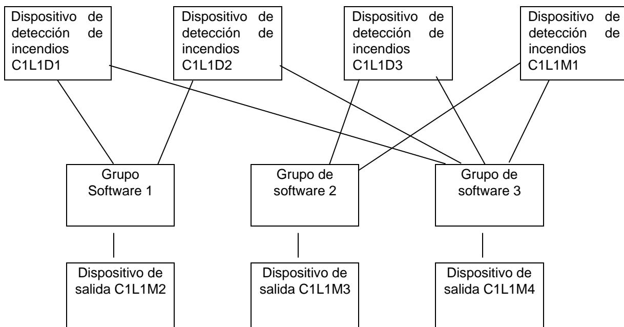
El módulo de salida **C1L1M2** está asociado al grupo **G1** y se activará en caso de alarma en los detectores **C1L1D1** y **C1L1D2**.
