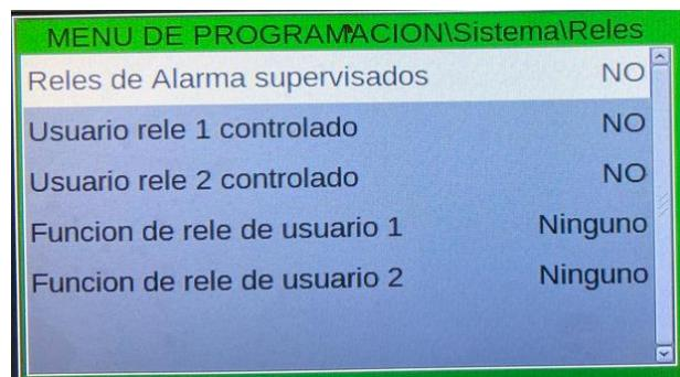
Esta función le permite definir la funcionalidad de la salida de usuario programable disponible en el panel. Seleccione la salida deseada y luego use las de flechas para seleccionar el elemento que debe cambiarse. Pulse la tecla ENTER para confirmar la selección.
