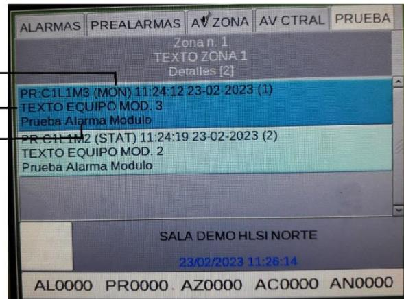
Al presionar la tecla enter , se visualiza todos los elementos probados, indicando lazo, tipo de equipo y texto del equipo.
