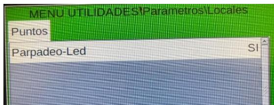
Si "NO" es seleccionado para la función "Parpadeo-Led", entonces los LED de todos los dispositivos que estén conectados a la central no parpadearán en estado normal.
