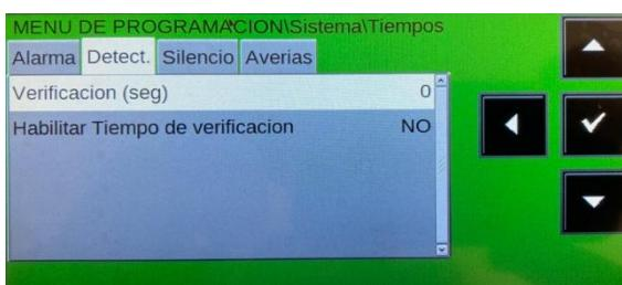
El tiempo de verificación del detector permite a la central verificar todos los detectores, el tiempo establecido, antes de confirmar la posible alarma. El tiempo de verificación del detector se puede programar en segundos (máx. 50 segundos).
