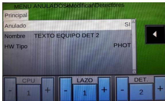
Cuando un detector está **anulado**, se impide que la central reciba alarmas y averías del detector.
