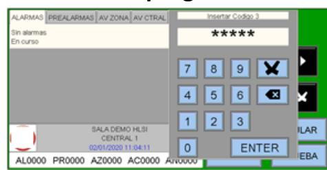
Pulsando el botón "PGRM" se puede acceder al menú de programación para configurar el sistema o realizar cambios en la programación.
