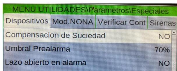
Para cambiar la función "Compensación de suciedad", pulse la tecla ENTER; Utilice las teclas de flechas para cambiar el parámetro; Cuando haya terminado, presione la tecla Enter para confirmar.
