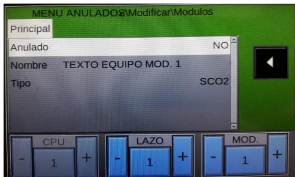
Cuando un módulo está **anulado**, se impide que la central reciba alarmas y averías del módulo, en el caso de módulos de salida también se evita su posible activación.
