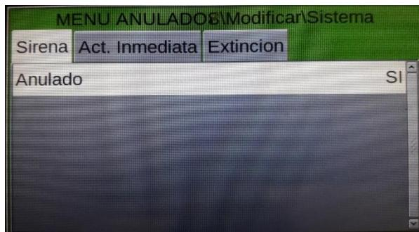
Para cambiar este parámetro en esta pestaña, pulse la tecla ENTER y utilice las teclas de flechas para seleccionar **Sí** o **NO**. A continuación, pulse la tecla ENTER para confirmar el valor.
