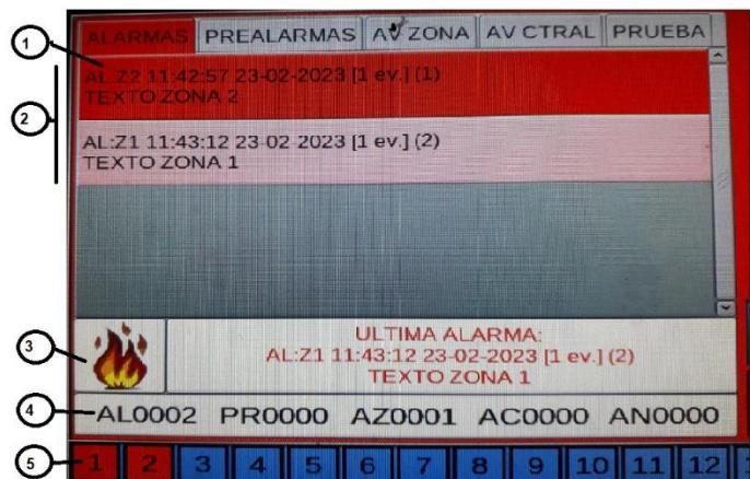
La siguiente pantalla aparece cuando la central está en la condición de alarma de zona. Usando las flechas se puede seleccionar la zona en alarma.
